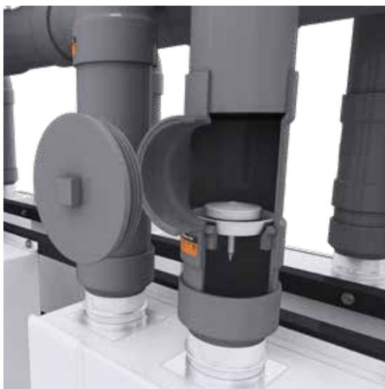
Le premier clapet antiretour spécialisé à obtenir la certification à la norme ULC S636, offert en PVC et en PVCC dans un diamètre de 4 po. Le clapet antiretour est conçu pour s'installer sur le tuyau d'évacuation vertical de chaque appareil afin d'empêcher les gaz de combustion de retourner dans l'appareil.
