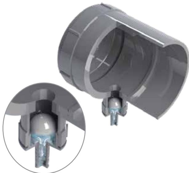
La conduite de drainage de condensat avec regard de nettoyage Système 636 est conçue pour s'installer à l'extrémité du collecteur d'évacuation afin d'assurer le drainage du condensat et de toute accumulation d'eau de pluie. La conduite de drainage de condensat avec regard de nettoyage est offerte en PVC et en PVCC, dans des diamètres allant de 6 po à 12 po.
