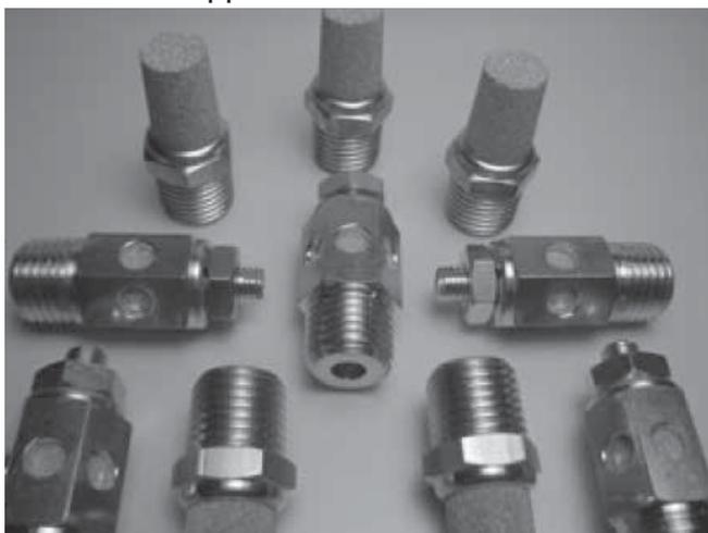
Muni d'un élément filtrant en bronze fritté poreux, fixé aux raccords de tuyauterie en laiton. Il sert à diffuser l'air et à réduire le bruit à la sortie des orifices d'échappement des valves pneumatiques à un niveau acceptable, satisfaisant aux exigences OSHA sur le bruit. Ce silencieux sert aussi de filtre, empêchant tout contact entre l'atmosphère corrosive et l'intérieur de l'actionneur, d'où une prolongation de la durée de vie utile de celui-ci.
