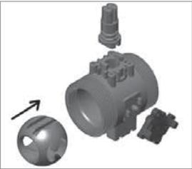
1. Remettre dans leurs positions respectives les joints toriques de tige (3), le joint torique du corps (9), les joints toriques du siège de la boule (8) et les sièges de boule (5) dans leur position appropriée.
