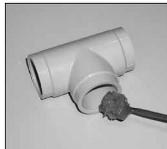
L'assemblage d'un système BlazeMaster lorsque la température est très basse (en dessous de 4 °C (40 °F)) ou très élevée (au-dessus de 38 °C (100 °F)), nécessite une attention particulière. Par temps froid, il faut augmenter la durée de prise. Lorsqu'il fait très froid, s'assurer que la colle n'est pas «gélifiée». Une colle «gélifiée» doit être éliminée. Par temps très chaud, s'assurer que les deux surfaces à assembler sont encore humides (présence de colle) lors de l'assemblage.
