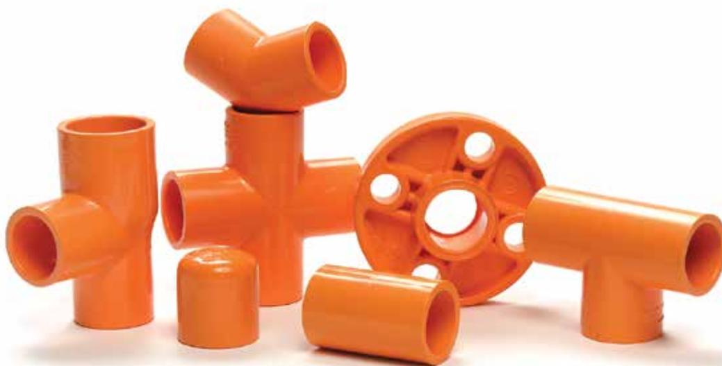
Le PVCC BlazeMaster de IPEX est un matériau robuste, résistant à la corrosion, mais qui ne possède pas la résistance mécanique de l'acier. Il faut donc prendre un minimum de précautions lors de la manipulation des tuyaux et raccords BlazeMaster. Il ne faut pas les faire tomber ni rien laisser tomber dessus. Si un tronçon de tuyau a été égratigné, fendu ou rayé par suite d'une mauvaise manipulation, le couper et le jeter.
