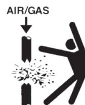
**L'utilisation d'air ou de gaz comprimés dans des tuyaux et raccords en PVC/PVCC/PP/PVDF peut provoquer une rupture par explosion et causer des blessures graves ou mortelles.**
