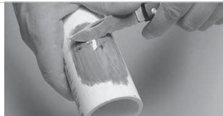
Vérifier la pénétration ou le ramollissement sur un morceau de rebut, avant de débiter l'installation ou lorsque le temps change au cours de la journée. À l'aide d'un couteau ou autre objet aiguisé, gratter la surface enduite à partir du rebord. La pénétration est suffisante lorsque vous pouvez enlever une épaisseur de quelques millièmes de pouce des surfaces enduites d'apprêt.
