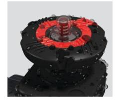
Le volant et le chapeau sont fabriqués en polypropylène armé de verre (GFPP), assurant une haute résistance mécanique et une excellente résistance à la corrosion. Le volant manuel et le chapeau sont entièrement étanches à l'eau; autrement dit, tous les composants métalliques internes sont isolés de l'environnement extérieur.
