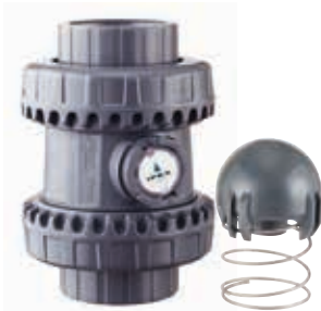
Clapets de non-retour à ressort SSE Dimensions : 1/2 à 4 pouces
