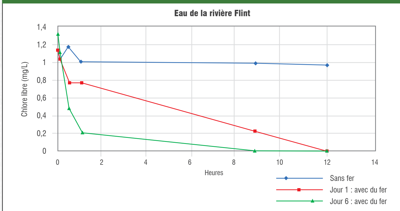
FIGURE A.26 : DÉCLIN DE LA TENEUR EN CHLORE DANS L'EAU DE LA RIVIÈRE FLINT EN PRÉSENCE ET EN ABSENCE DE FER
